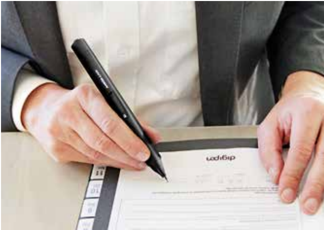
Der Stift speichert die Daten und sendet sie verschlüsselt an einen Server.
